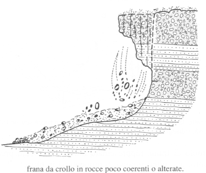
frana da crollo in rocce poco coesive o alterate.
